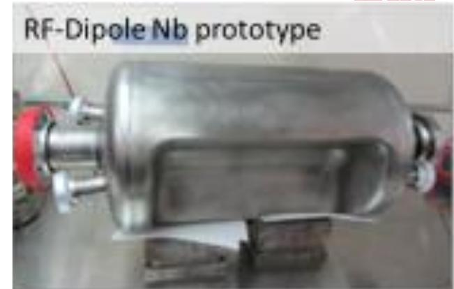
RF-Dipole Nb prototype
