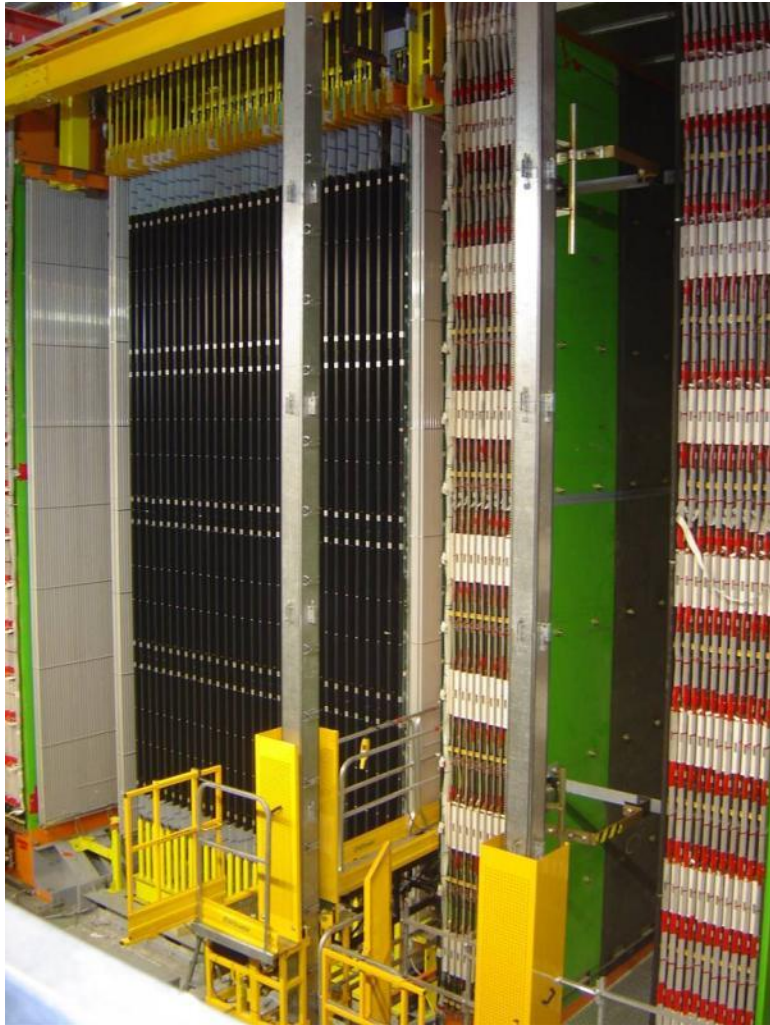
Scintillator planes 5900 m 2 8064 7m long drift tubes
