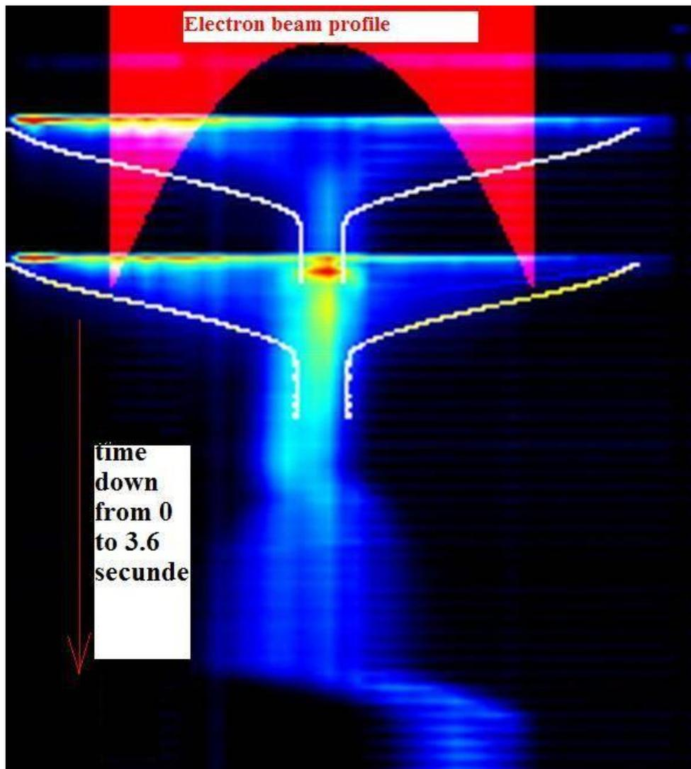
Рисунок демонстрирует измеренный профиль ионного пучка (сигнал с профилометра). Первоначально широкий ионный пучок инжектируется в LEIR и занимает практически всю разрешенную апертуру 50 мм. Затем пучок быстро охлаждается до размера около 2 мм, через 0.2 сек. происходит новая инжекция широкого (горячего) пучка, и он опять охлаждается. Далее охлаждаемый ток выключается, и накопленный пучок немного расширяется из-за внутривидеопучкового рассеяния.
