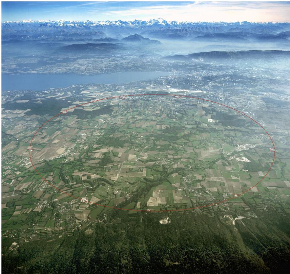
В начале 1980-х годов был предложен проект ускорителя, осуществляющего столкновения электронов и их антиподов – позитронов, – большой электрон-позитронный коллайдер (LEP). Осенью 1983 года началось строительство LEP. В долине Женевского озера на глубине ста метров был вырыт кольцевой туннель общей длиной 27 километров. Качество подземных работ было столь высоким, что, когда в 1988 году два конца туннеля соединились, расхождение между ними составило всего один сантиметр.
