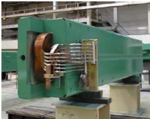
Коммутирующие сверхпроводящие шины (bus-bars).
