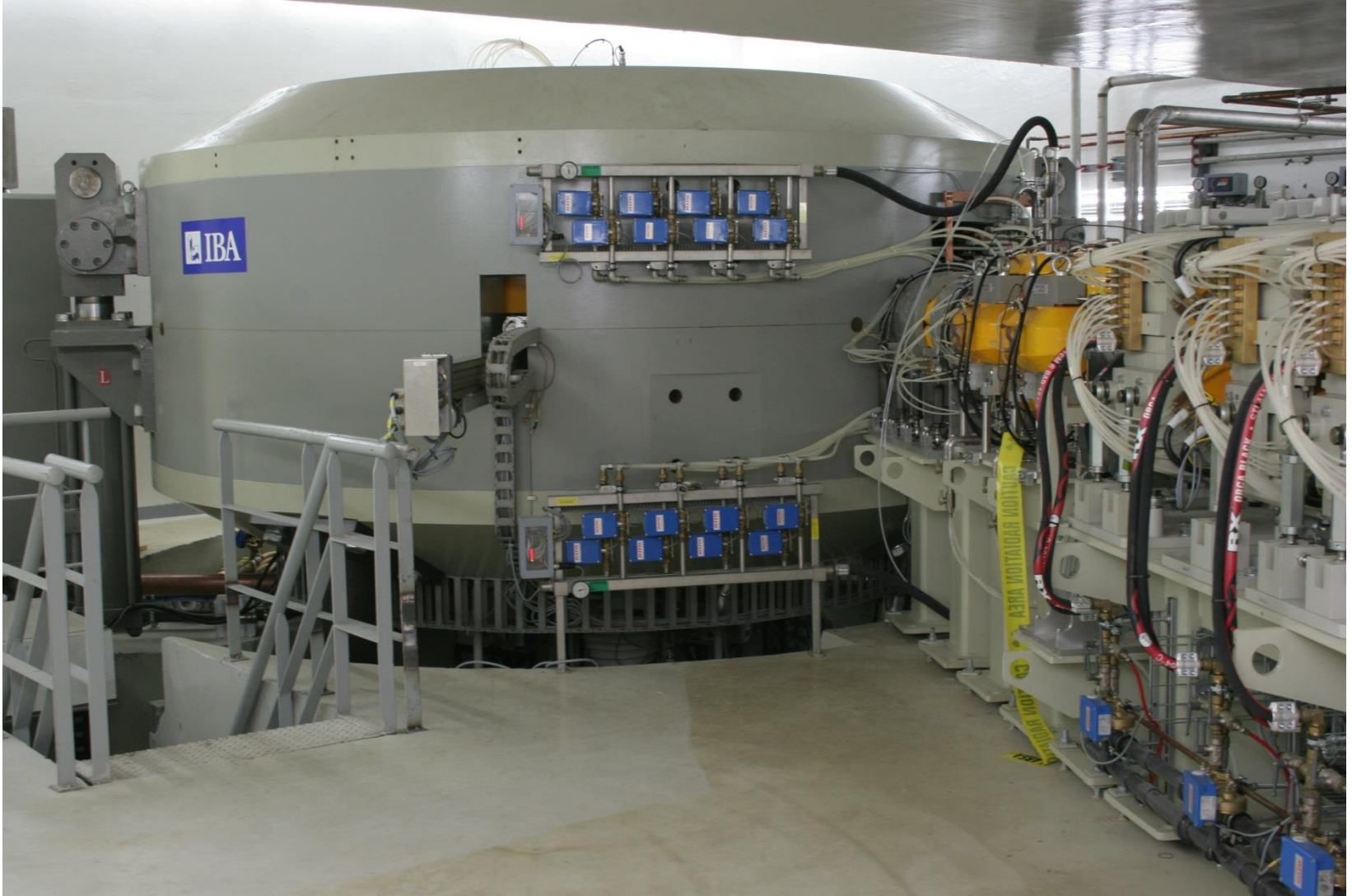
Medikal alanda (kanser terapisinde) kullanılan bir siklotron.
