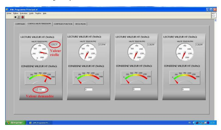
On fait varier la tension UPM1 du PM1 sur la plage de fonctionnement (800-1300 V).
