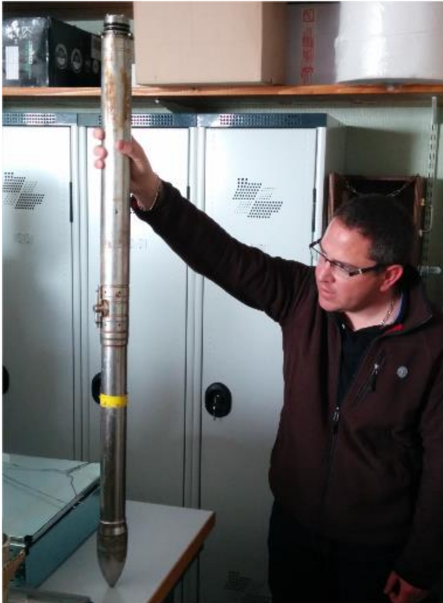
Sonde utilisée avant au port, fonctionnant avec une source scellée radioactive gamma.
