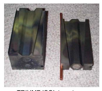
TRIUMF ISOL target Diffusion bonded Mo foils
