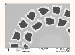
Monel Matrix  $30 \text{ MgB}_2 \text{ filaments}$  Nb + Ni barrier $ff \sim 10.4 \%$
