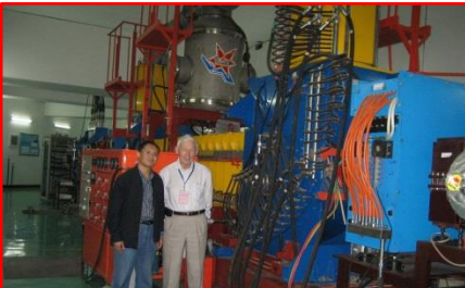
300 keV electron cooler (Lanzhou)
