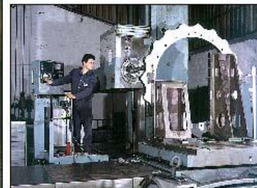
BORING CNC-SHAFT \Phi 120 -(2 x 2 x 2 m)
