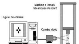
Essais mécaniques et vidéotraction
