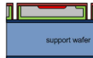
g) Annealing and edge oxidation
