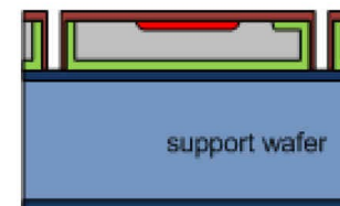
g) Annealing and edge oxidation
