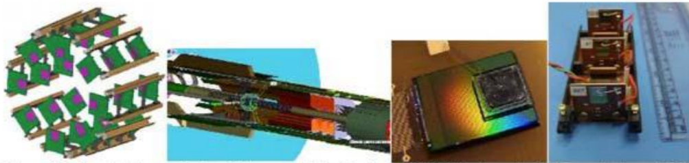
Figura 2: Da sinistra a destra: Disegno della struttura del PLT a tre strati. La posizione del PLT rispetto al punto di collisione ad LHC. Un diamante a singolo cristallo (SCVD) montato sul ROC. Il telescopio di tre rivelatori SCVD testato al CERN sulla linea di fascio SPS.
