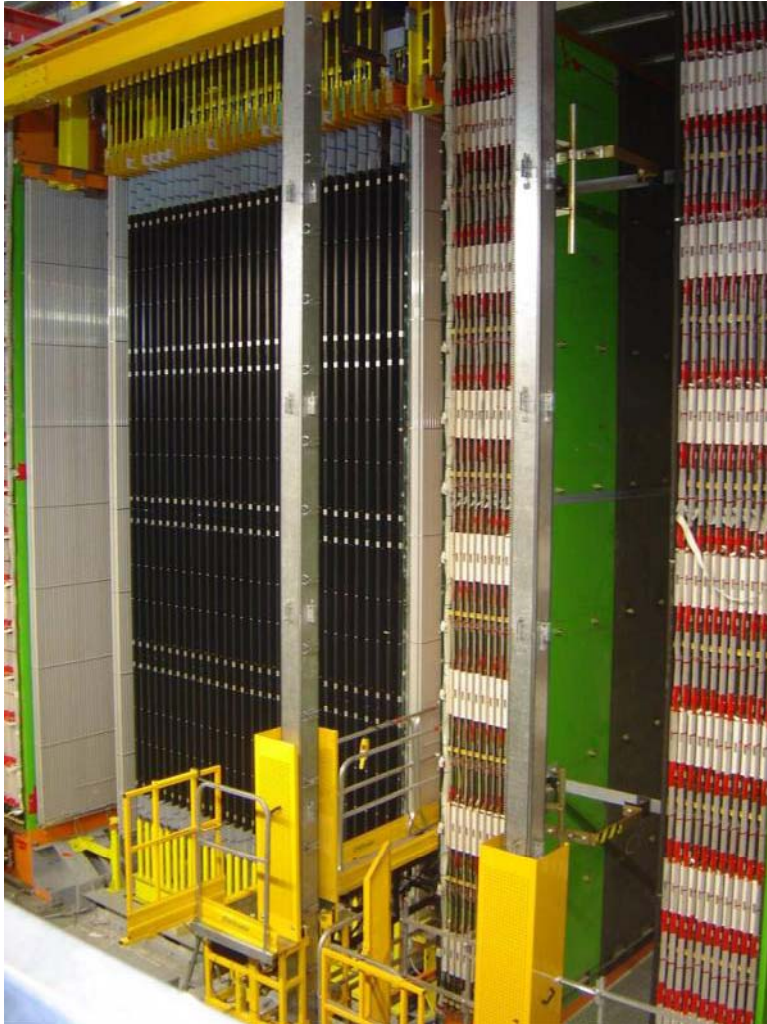
Scintillator planes 5900 m 2 8064 7m long drift tubes
