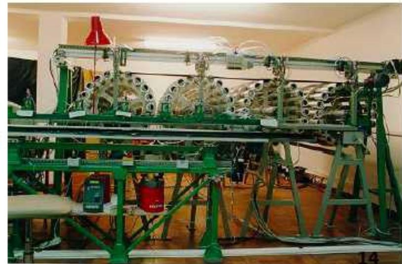
Robot para inserção de fibras ópticas em perfis de plástico desenvolvido e construído em Portugal
