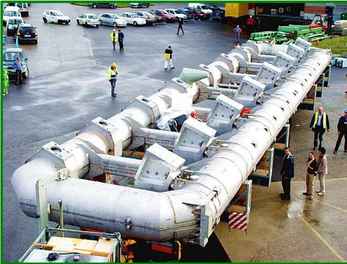
**Transport und Absenkung der ersten supraleitenden Barrel Toroid Spule**
