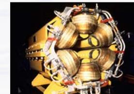
Quadrupole = **defokussierend** in vertikaler Ebene
