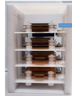
SPT detection unit, with natural Cd in between detectors Unité de détection SPT, avec du cadmium naturel entre les détecteurs
