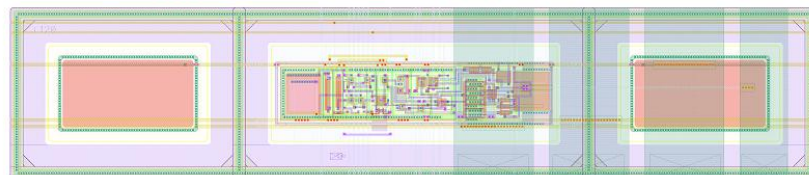
HV-CMOS 50x150 um pixel (AMS350)
