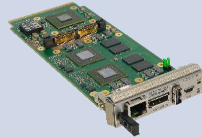
NVIDIA GPGPU Module
