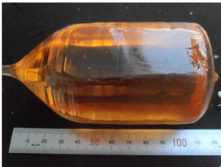
LGT Ingot 2'' Z orientation
