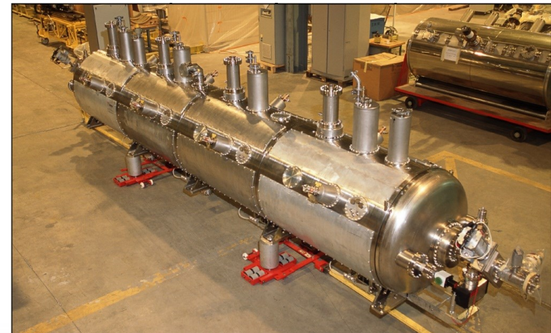
400 MHz ACS cryomodule
