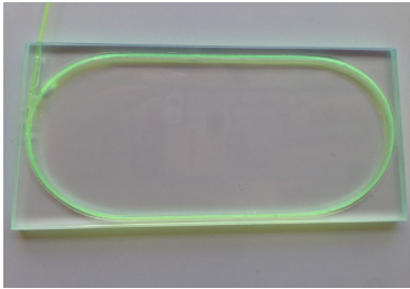
Eljen EJ-200 Scintillator Eljen EJ-500 epoxy Kurary Y-11 WLS fiber
