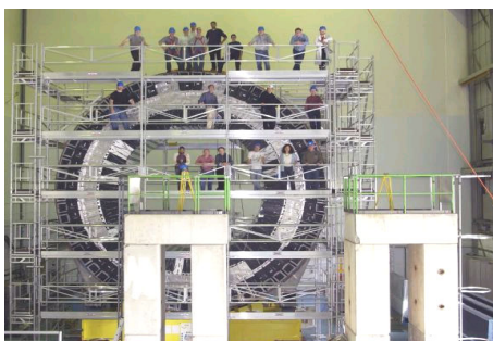
Fig. 9 : montage du Tile barrel Atlas - contrôle module par module par théodolite et distancemètre.
