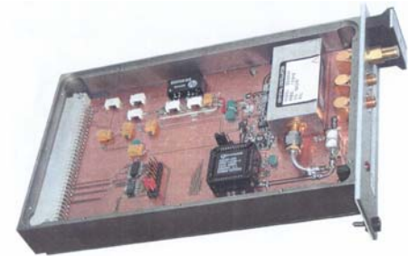
ELBE LLRF board A. Buechner, LLRF01
