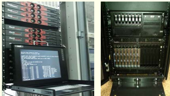
PC typu RACK i BLADE
