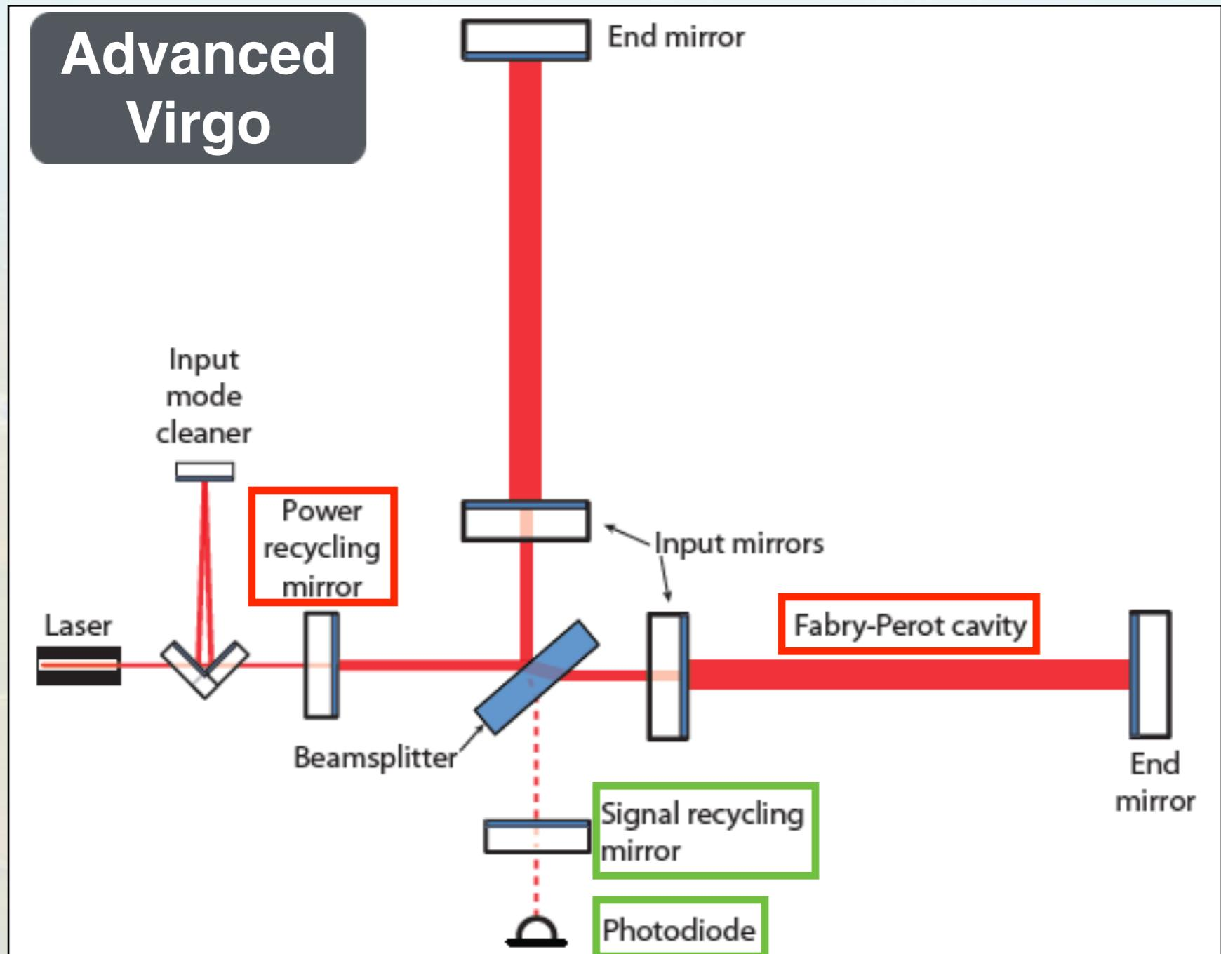
$$h_{\text{sn}}(f) \sim \frac{\lambda}{4\pi} \frac{1}{L} \sqrt{\frac{\hbar\omega}{P}}$$
