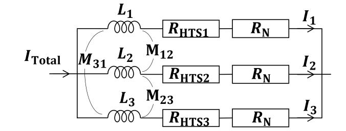
$$\begin{bmatrix} I_1 \\ I_2 \\ I_3 \end{bmatrix} = \begin{bmatrix} J\omega L_1 + R_N + \\ j\omega M_{21} \\ j\omega M_{31} \end{bmatrix}$$
