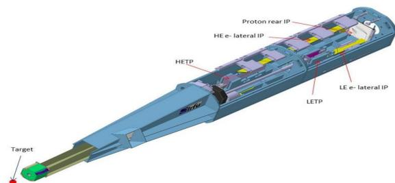
Fig. 2. SEPAGE spectrometer
