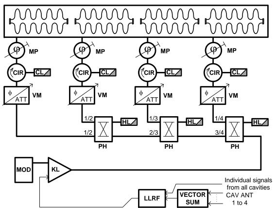
**KL** 5MW<sub>PK</sub> klystron
