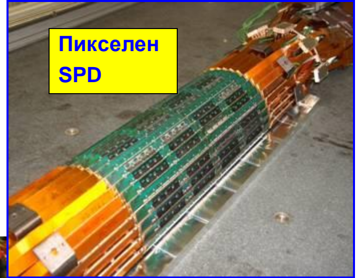
Вътрешен тракер ~ 10 m 2 Si , 6 слоя: пикселен, дрейфов, двустранен лентов
