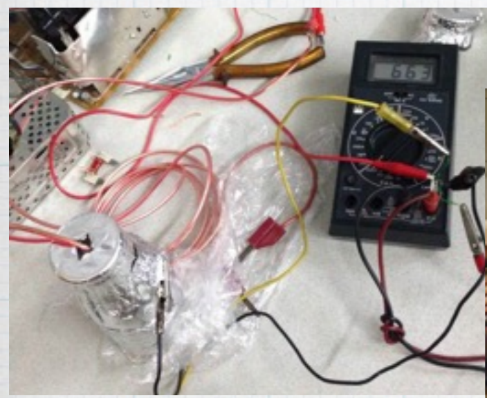
Tesla sarımı Ayran kutusu, tuzlu su ve alüminyum folyo ile leyden kavanozu = kondansatör
