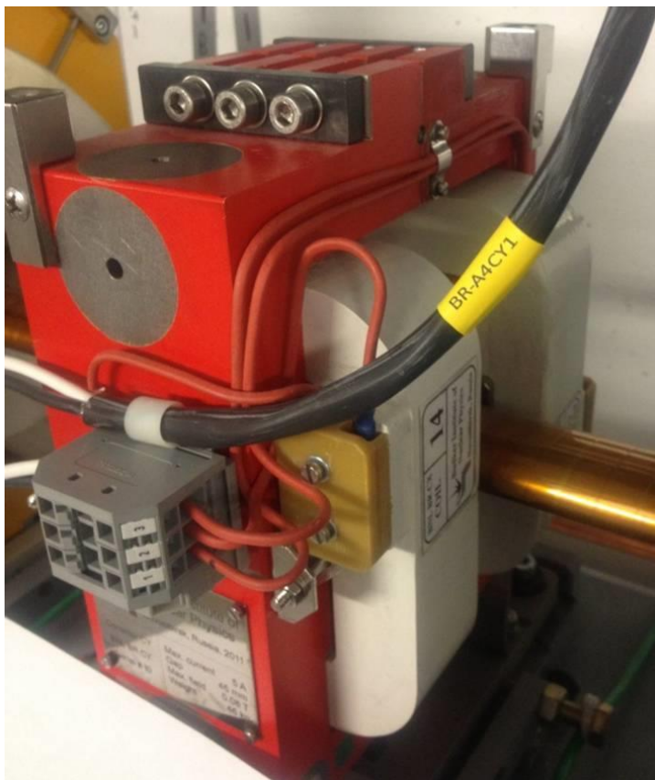
горизонтальный корректирующий магнит дипольный X корректор
