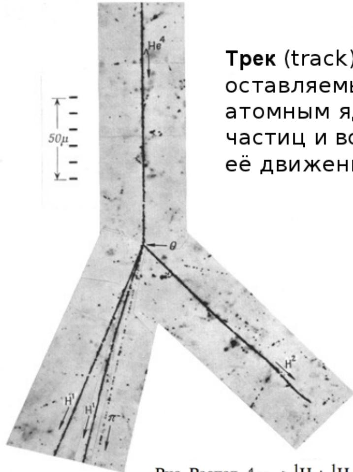
**Трек** (track) – видимый след, оставляемый *заряженной* частицей (или атомным ядром) в веществе детектора частиц и воспроизводящий траекторию её движения.
