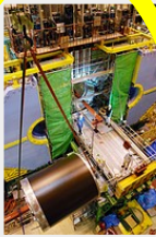
クレーンでつり上げられ、高エネルギー加速器研究機構の加速器「スーパーKEKB」に搬入される新型の「中央飛跡検出器」=13日午前、茨城県つくば市の同機
