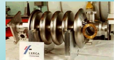
Cavité APT (Los Alamos) 700 MHz - \beta = 0,64
