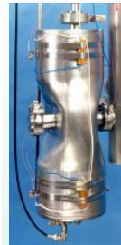
Résonateur demi-onde (Argonne) 355 MHz - \beta = 0,12
