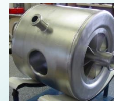
Cavités spoke (CNRS Orsay) 352 MHz - \beta = 0,15 et 0,35
