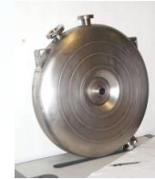
Cavité ré-entrante (Legnaro) 352 MHz - \beta \geq 0,1
