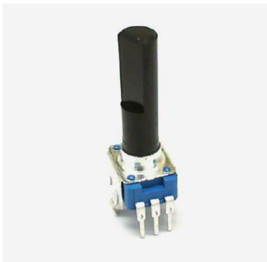
Rysunek 7-1; Potencjometr obrotowy ze StarterKit dla NiMyRio.
