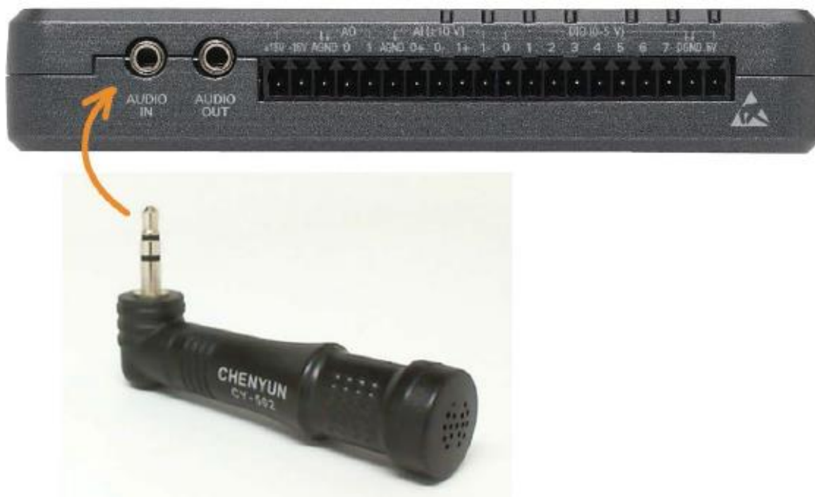
Rysunek 10-2; Układ pokazowy interfejsu mikrofonu elektretowego, podłączonego do NiMyRio, zalecany schemat połączeń do gniazda AUDIO IN NiMyRio_MXP
