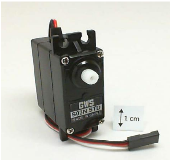
Rysunek 17-1; Serwomechanizm GWS S03N STD, z zestawu MechatronicsKit dla NiMyRio.
