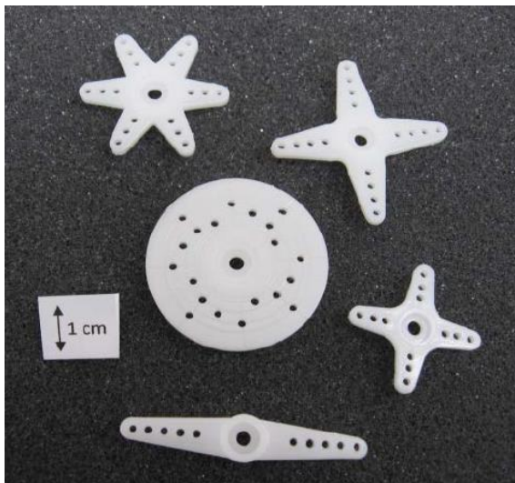
Rysunek 17-3; Ramiona sterowania serwomechanizmu, dołączone do GWS S03N STD
