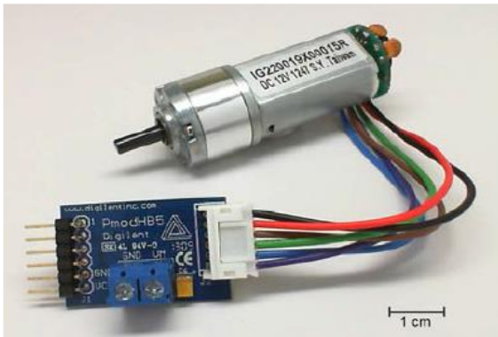
Rysunek 18-1; Układ napędowy z przekładnią redukcyjną, sterowany mostkiem-H, z zestawu MechatronicsKit dla NiMyRio.
