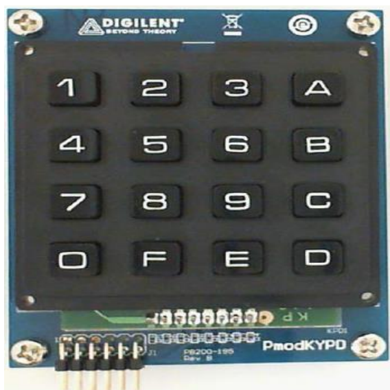
Rysunek 25-1: Klawiatura 4 x 4, z EmbeddedSystemsKit dla NiMyRio.
