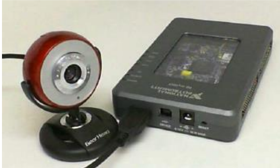
Rysunek 36-1: Web kamera podłączona do portu USB, z zestawu AdditionalDevices Kit dla NiMyRIO
