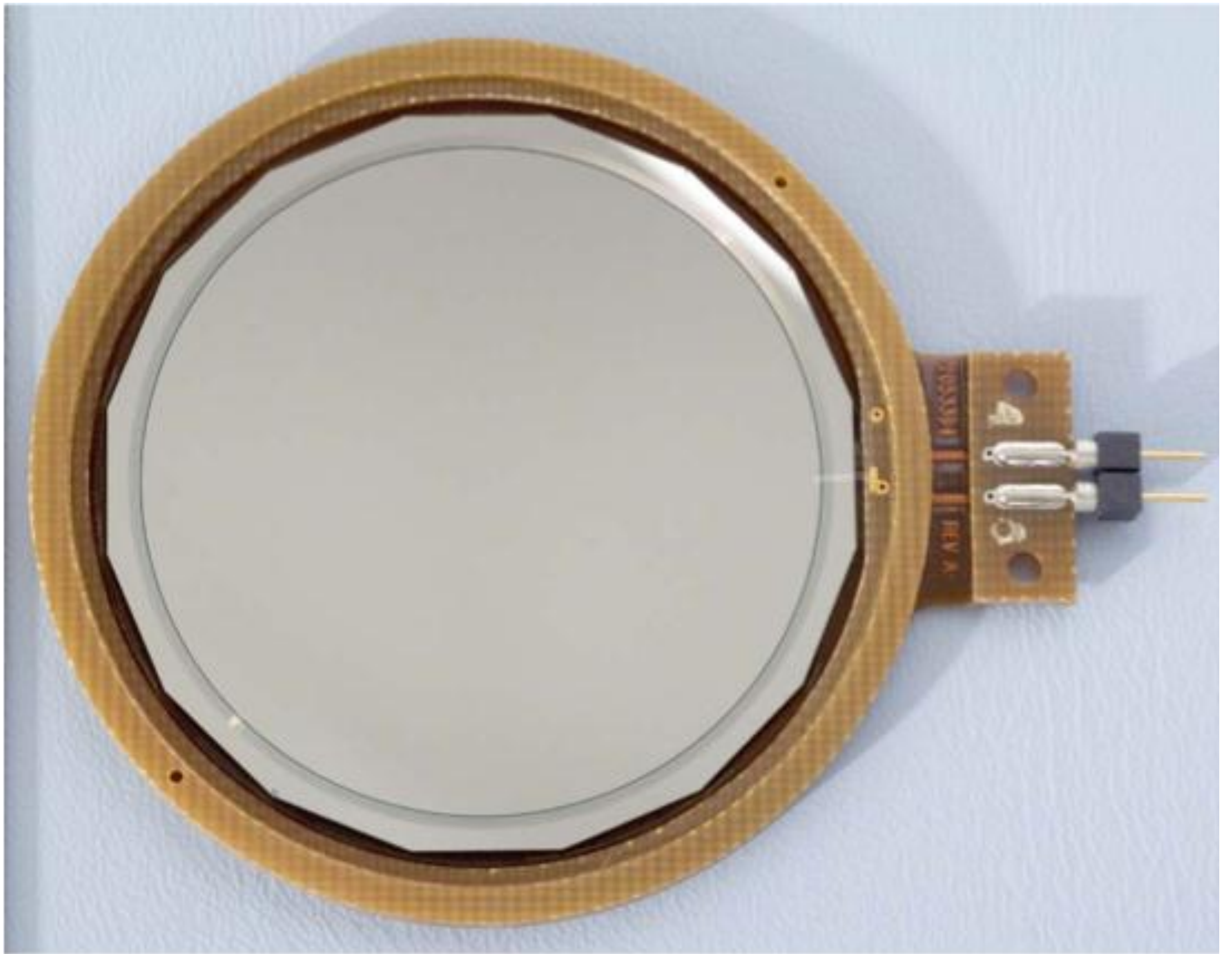
Fig. 9 Shows a HET stack detector (junction side)
