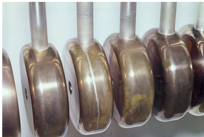
Driftröhren des LINAC2
