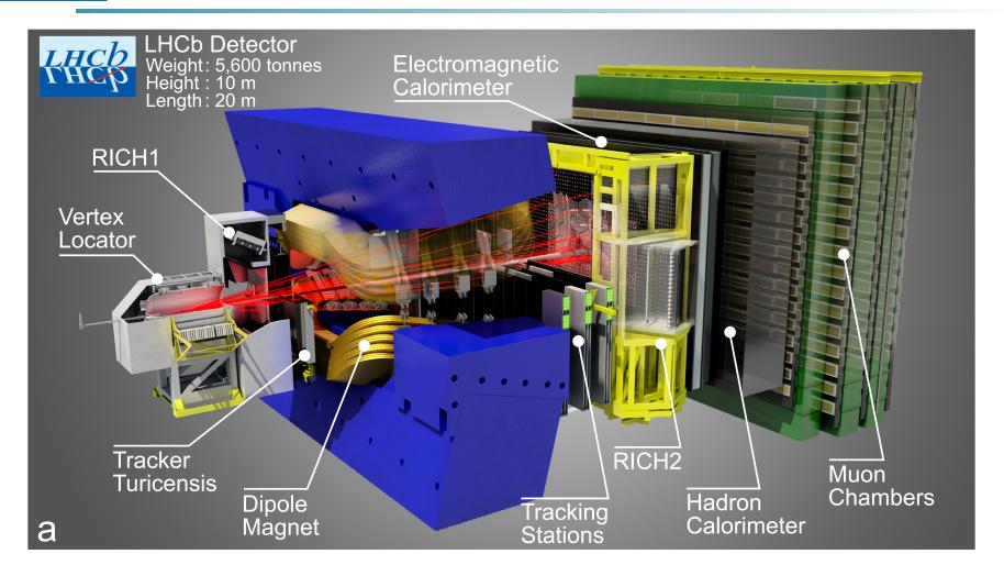
proper time:  $\Delta \tau \simeq 45 fs$  impact parameter:  $\sigma_{\rm IP} \simeq 35 \,\mu m$   $\Delta p/p \simeq (5-7) \times 10^{-3}$
