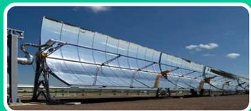
Impianti solari termodinamici
