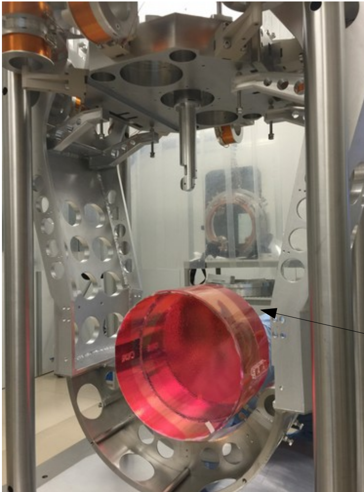
Fibres en verre (fused silica) (diamètre 400\ \mu\text{m} et longueur 0,7\ \text{m} )
