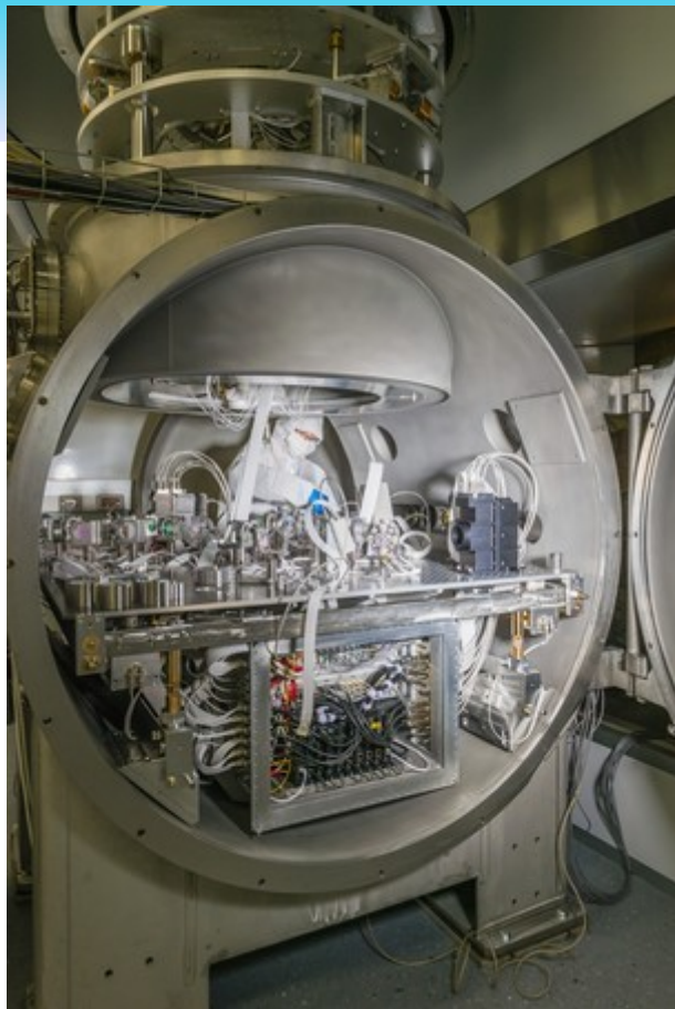
Bancs optiques suspendus sous vide
