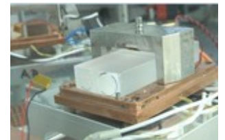
Cavité optique, sélecteur de mode et fréquence
