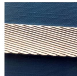
Свитые провода спрессованы в плоскую двухслойную структуру. Полиамидная изоляция кабеля имеет высокую электрическую прочность, радиационную стойкость, а также эластичность, как при комнатной температуре, так и при температуре жидкого гелия.
