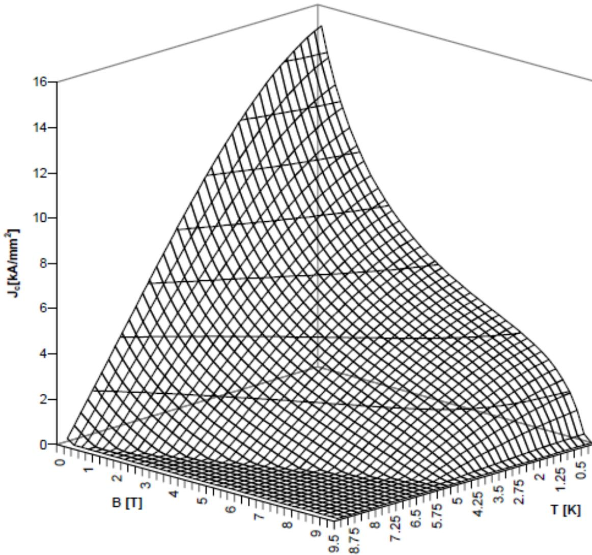
Состояние сверхпроводника с плотностью тока  $J$  [ $\text{A/mm}^2$ ], помещенного в магнитное поле  $B$  [ $\text{Tл}$ ] при низких температурах  $T$  [ $\text{K}$ ], можно описать некоторой критической поверхностью в координатах  $J$ ,  $B$ ,  $T$ . Если хоть один из этих параметров превысит соответствующее "критическое" значение - это приводит к переходу сверхпроводника в состояние нормальной проводимости. Иными словами, происходит срыв сверхпроводимости.
