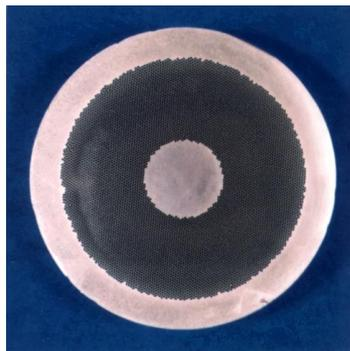
Отдельные жилы провода переплетаются таким образом, чтобы выровнять распределение токов и минимизировать наведенные вихревые токи при изменении магнитного поля.
