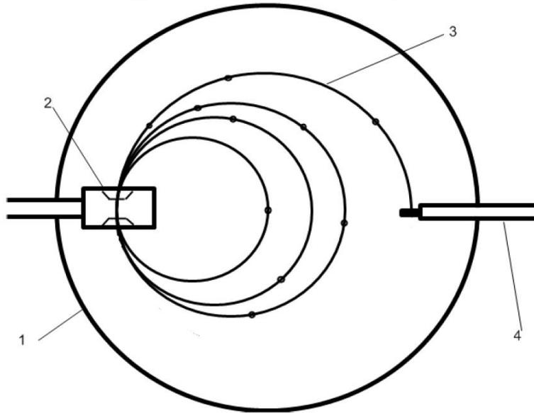
*Схема устройства микротрона.*
