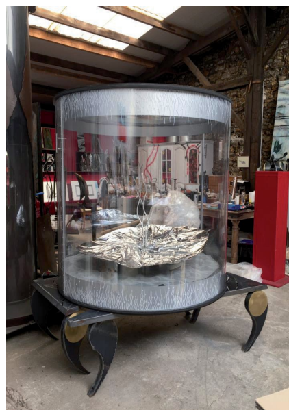
La « MoonBox » : Un cabinet chauffant pour simuler les températures sur le sol lunaire, utilisé pour tester l'ouverture et la fermeture de VITAE.
