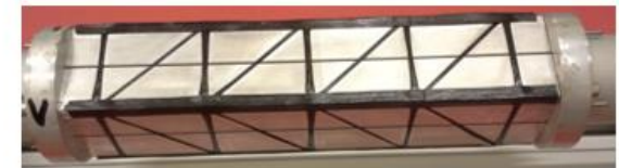
4. Placement of corner L-sections (UD prepreg)
