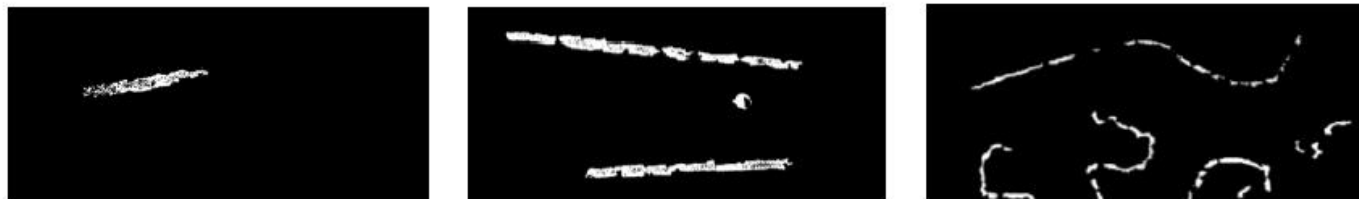
Abb. 2 Nebelkammerspuren von Alpha-Teilchen (links), Protonen (Mitte) und Elektronen (rechts). (Quelle: KIT)
